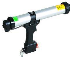
L'**AEROGUN 400** est un pistolet pneumatique pour sachet de 400 ml. L'air comprimé pousse un piston qui vient appuyer sur la poche. Permet un gain de productivité et une dépose plus précise du mastic.
